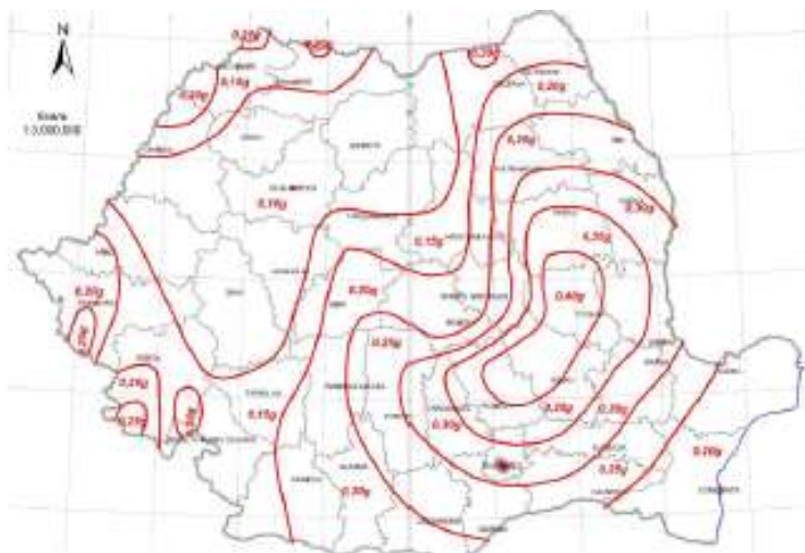
Figura 27 – Zonarea teritoriului în termeni de valori de vârf ale accelerației terenului ag
