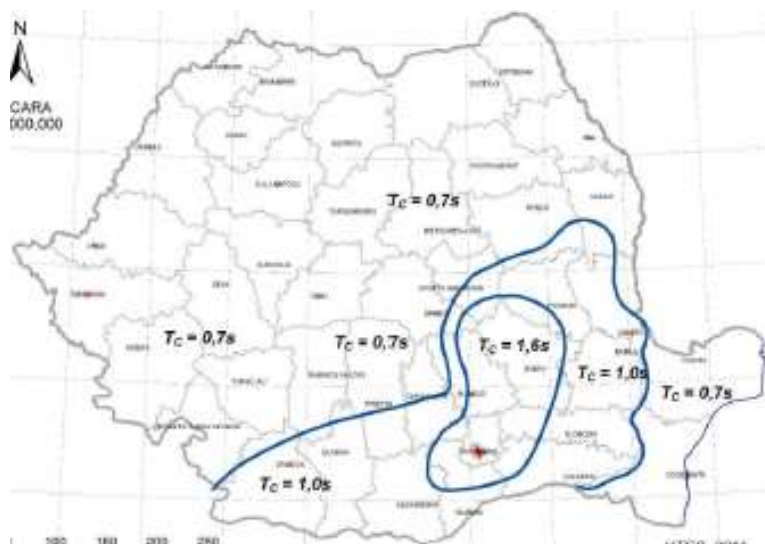
Figura 28 – Zonarea teritoriului în termeni de perioada de control (colt), TC, a spectrului de răspuns
