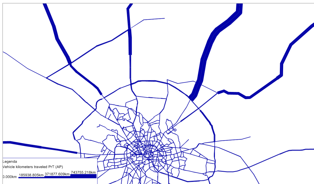
Figura 4-23. Reprezentarea la nivelul grafului rețelei a prestației pentru fiecare arc la nivelul anului de bază - 2016 (vehiculexkm) (Sursa: model de transport aferent SF, Consultant)
