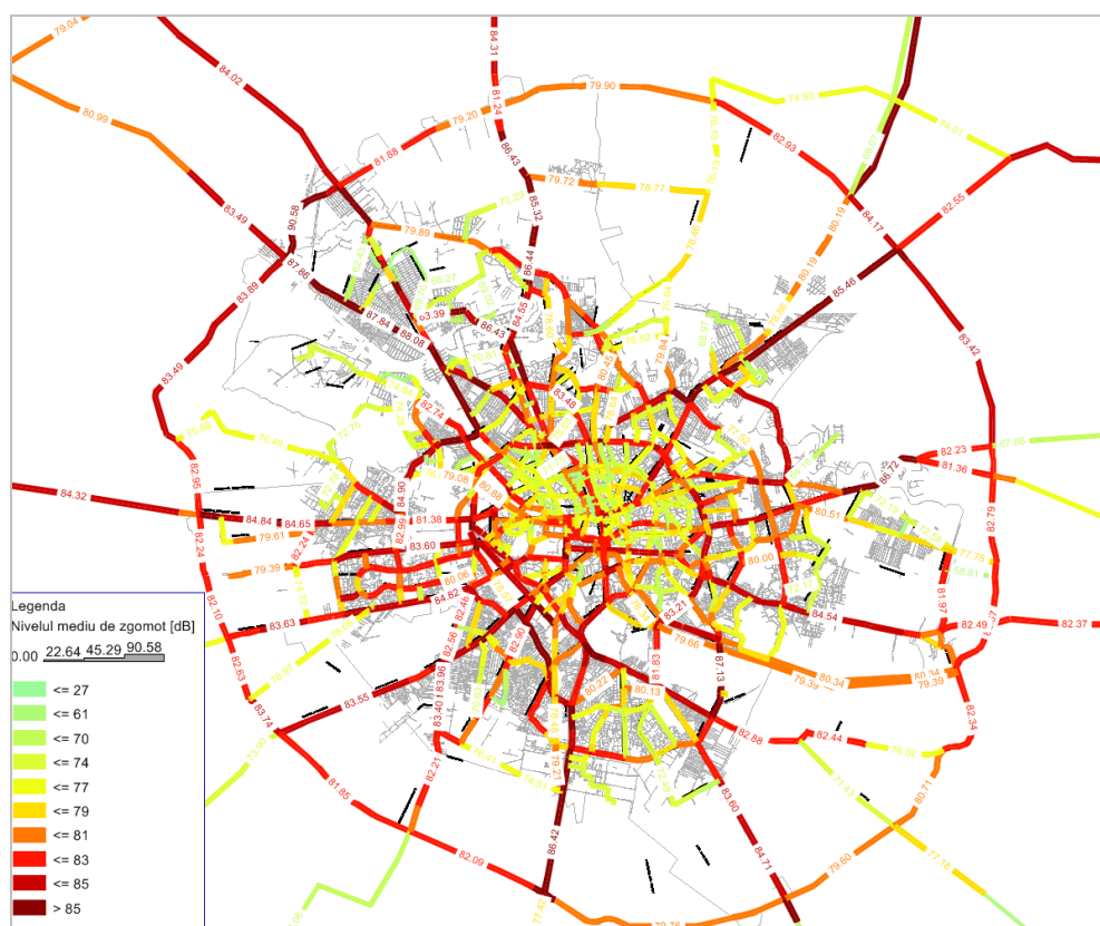
Figura 4-43. Nivelul mediu al zgomotului calculat pentru anul de bază -dB Sursa: model de transport aferent SF, Consultant)
